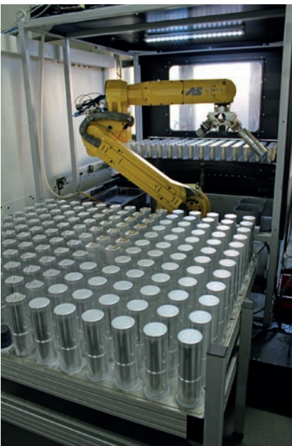
Bild 2: Dieser Roboter bedient zwei 5-Achs-Fräsbearbeitungszentren, zusätz- liche Behandlungs- und Reinigungsein- heiten sowie mehrere Palettierplätze
