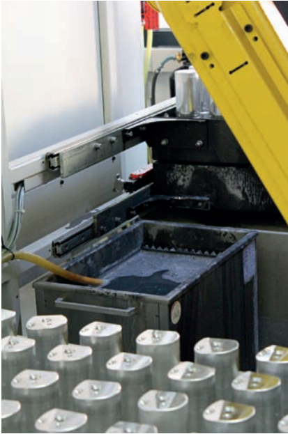
Bild 5: Das abschließende Ultraschallbad entfernt neben restlichem Schmutz auch alle Fett- und Ölhaftungen
