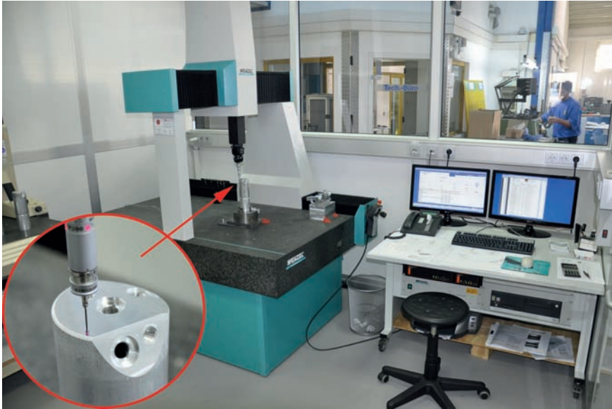
Bild 3: Dimensionskontrollen erfolgen in einem klimatisierten Reinraum. Die Koordinatenmessmaschine liegt mit einer Messgenauigkeit von \pm 3 über dem üblichen Niveau
