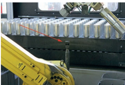
Bild 4: Mit Hilfe der Bürste werden Grate im Bereich der ineinander verlaufenden Bohrungen sicher entfernt
